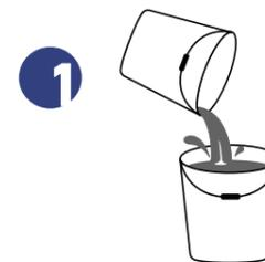
1 Komponente B in Komponente A füllen
